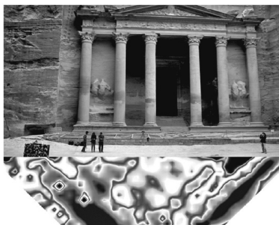
3. Ubicazione del profilo di indagine (in alto) e elaborazione della sezione elettrica verticale (in basso)
